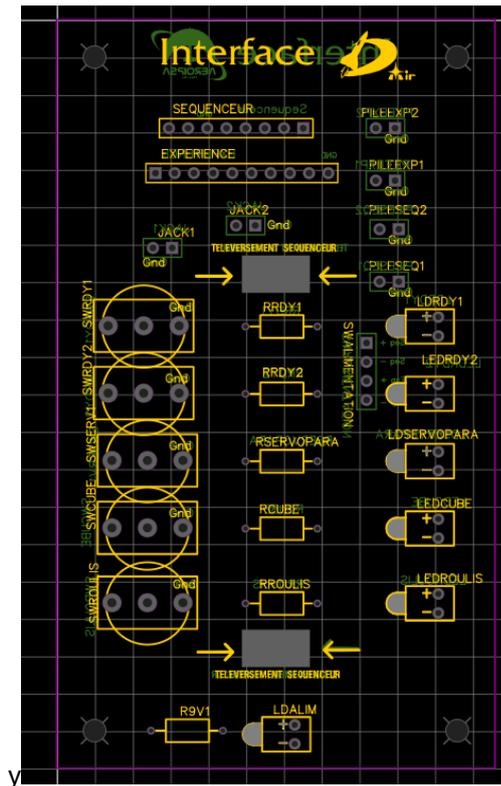
La carte possède 6 Leds : une pour l'alimentation, une pour chacun des jacks, une pour le déclenchement du servomoteur du parachute, une Leds pour le servomoteur responsable du largage du CanSat et enfin un annonçant le début du contrôle de roulis (non utilise)
