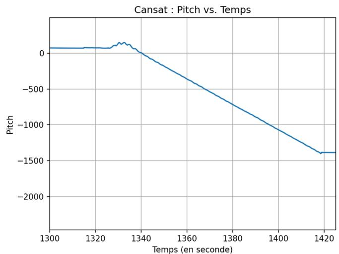
Sur l'axe de tangage (pitch) au niveau de la Fusex, il y a un mouvement constant sous forme d'oscillation. Cela représente probablement la descente en parachute, les mouvements de la fusée sur cet axe.
