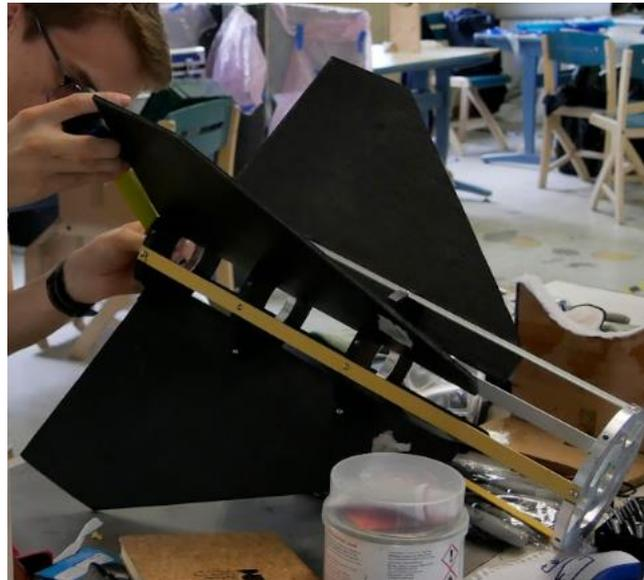
Le tube quant a été lui fut réalisé en fibre de verre et de la mousse autour d'un moule de PLA.
