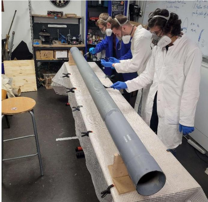
La structure de la fusée est dite « peau porteuse » c'est-à-dire que la peau de la fusée porte les blocs
