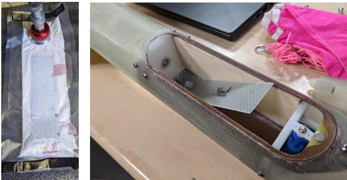
Figure 4, Photos de la réalisation du ressort en fibre de verre
