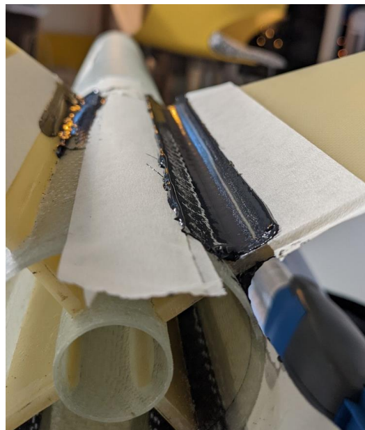
Figure 2, Photo du processus de collage des ailerons
